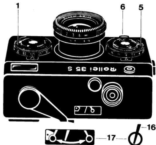
Dans cette position: tourner la bague de réglage du diaphragme 5 et régler l'aiguille de référence rouge 17 sur l'aiguille de mesure 16 (si c'est nécessaire, choisir un temps de pose plus court ou plus long, sur la bague 1).
